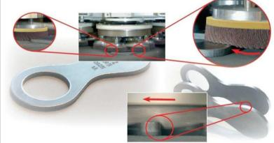
Entgraten und allseitige Kantenverrundung von gebrannten, gelaserten und gestanzten Blechteilen unterschiedlicher Materialqualitäten im Trocken- oder Nassverfahren. Die Vliesschleifteller sind gruppenweise auf den Planetenköpfen zusammengefasst. Sie drehen sich um sich selbst und rotieren gleichzeitig um das Sonnenrad wodurch eine optimale Bearbeitung an allen Kanten gewährleistet ist.
